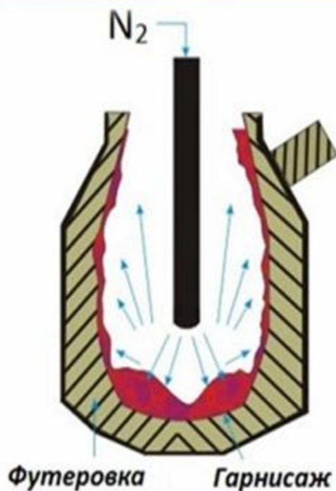
Рисунок 3- Схема раздувки шлака
